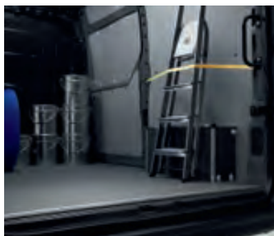
Zijwanden en vloer antislip-polypropyleen 6 mm
