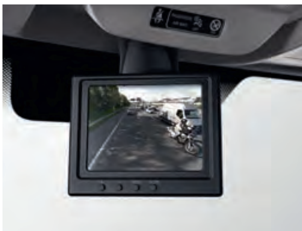
3 PERMANENT ZICHT NAAR ACHTER met een camera achterop het dak voor een zicht zoals in een achteruitrijspiegel tijdens het rijden
