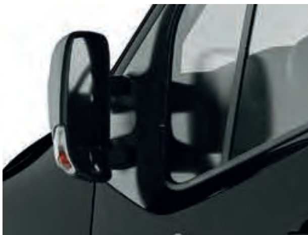
2 GROOTHOEKSPIEGELS met elektrische bediening en geïntegreerde richtingaanwijzers
